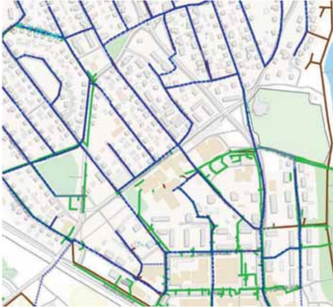
Kuva 25. Suunnittelualueelle vesi- ja viemäriinjastoa sekä hulevesiverkostoa on toteutettu olevan katuverkon mukaisesti. (Kuva: Äänekosken Energia Oy)
