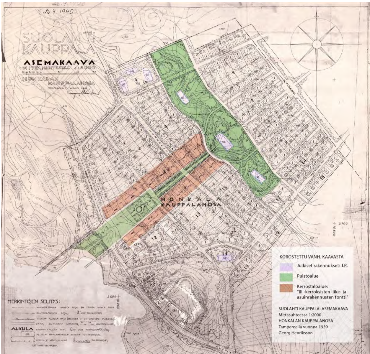
Kuva 11. Suolahden ensimmäinen asemakaava Honkalan kauppalanosasta 1939. Kaavaan on korostettu vihreällä suuret geometriset puistoalueet ja ruskealla kolmikerroksisten asuinkerrostalojen alue. Honkalan puolelle on suunniteltu Majalan koululta alkava julkisrakennusten kokonaisuus, jossa violetilla korostetut julkisrakennukset sijoittuvat rinteiden harjanteille yhtenäisellä puistoalueella, joka päättyy Honkalan tilaan. Keskimmäiseltä julkisrakennukselta lähtee viivasuora puistoakseli ent. sahan alueelle. Vaikka suunnitelma on kaupunkimainen ja mittava, olevaa rakennuskantaa on kuitenkin jokseenkin huomioitu tielinjauksissa nyk. Höökinkadun alkupään ja Honkalan tilan kohdalla. Suurten linjojen kohdalla pienet asuinrakennukset olisivat saaneet väistyä. Kuva: Äänekosken kaupungin arkisto
